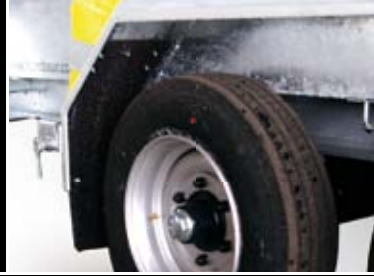
Anti-Spray- System in den gekanteten Kotflügeln (optional)
