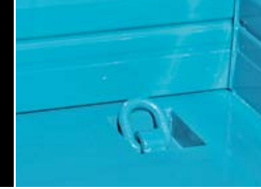
In der Brücke versenkte Zurringe
