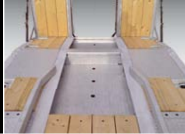
Ablage verzinkt für Baggerlöffel, auch 2-fach möglich (optional)
