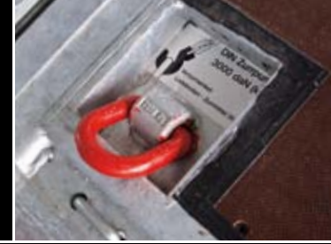
Zurringe im Brückenboden versenkt (optional)
