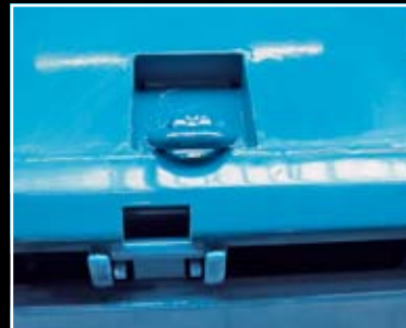
1 Paar zusätzliche Zurrpunkte im Brückenboden versenkt, wahlweise auch aufgeschweißt
