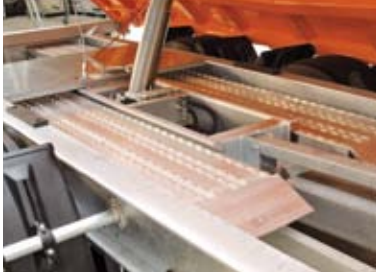
Auffahrampen unter der Brücke eingeschoben (optional)
