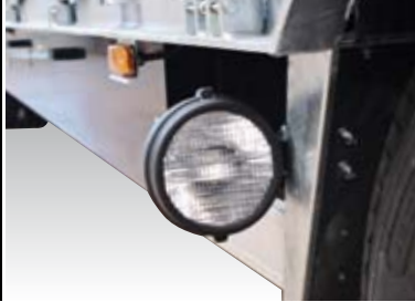
Ausklappbarer Arbeitsscheinwerfer (optional)
