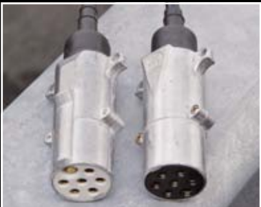
2 x 7-polige Verbindungskabel (ISO 1185 und ISO 3731)
