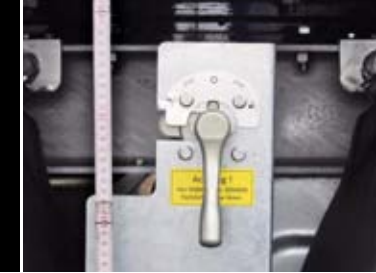
Luftfederung mit Heben- und Senkenfunktion
