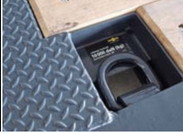
4 Paar Zurrringe bis 10000 kg Zugkraft
