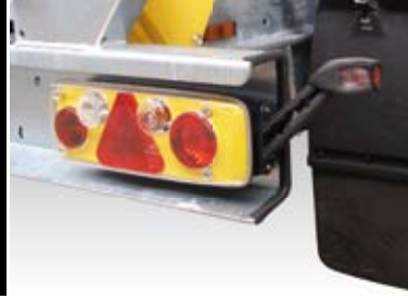
In den Rahmen geschützt eingebaute Multifunktionsleuchten
