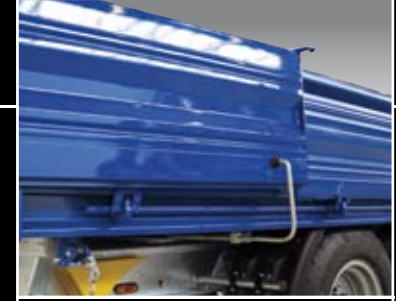
Drehstangenverschluss zur Sicherung der geöffneten Hecktüre
