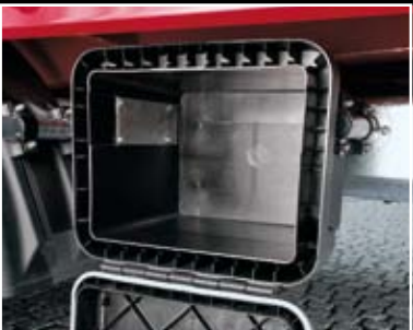
Kunststoff-Werkzeugkasten unter der Ladefläche (geöffnet)
