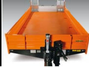
Rutsch- hemmender Brückenboden aus Stahl- tränenblech
