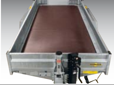
Brückenboden aus 27 mm Siebdruckplatten (optional)
