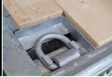
4 Paar Zurringe zur Ladungs-sicherung im Brückenboden versenkt
