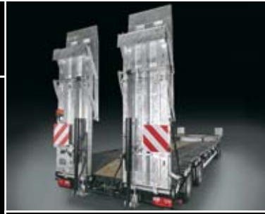
2-teilige hydraulische Rampen mit hydraulischer Seiten- verschiebung
