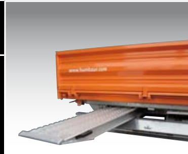
2 Aluminium-Bohlen, Tragkraft 8000 kg bzw. 16000 kg beim HTK 18
