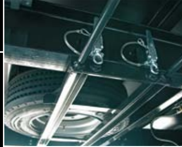
Ersatzradhalter als Korb unter der Ladefläche
