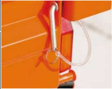
Arretierung der Bordwände in abgeklapptem Zustand
