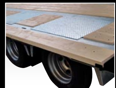
Hartholzbelag für Verbreiterung
