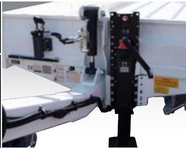
Hydraulisch höhenverstellbares Zugrohr
