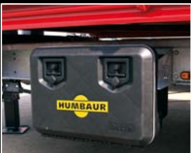
Kunststoff-Werkzeugkasten unter der Ladefläche (geschlossen)
