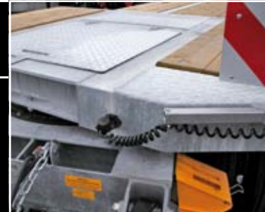
Rahmen verzinkt (nur möglich in Verbindung mit Holzboden)
