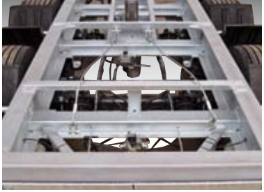
Im Tauchbad feuerverzinktes Fahrgestell
