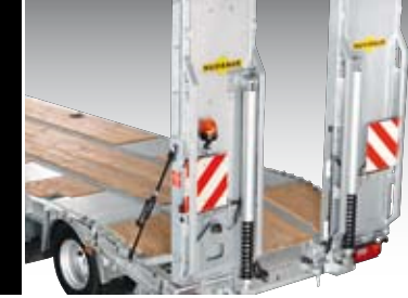
Rampen im Tauchbad feuerverzinkt mit Feder- hebwerk
