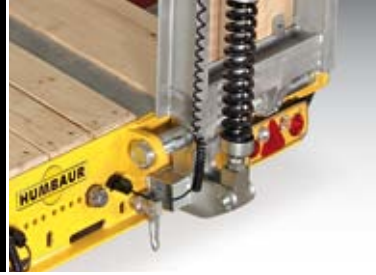
Manuelle Seiten- verschiebung der Rampen, optional auch hydraulisch
