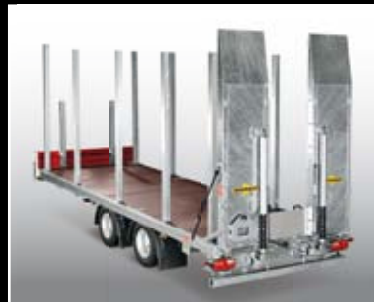
Steckungen und Rungentaschen in unterschiedlichen Abmessungen
