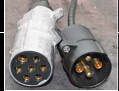
MAN-Zugfahrzeug: 1x4-poliger und 1x7-poliger Stecker
