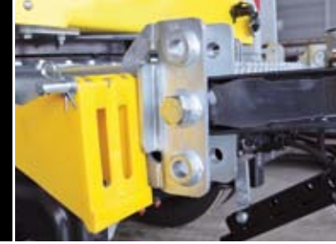
Höhenver- stellbare Zug- gabel durch 3 Bohrungen
