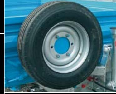
Ersatzradhalter an der Stirnwand
