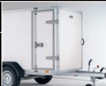
Seitentür mit Drehstangenverschluß von Innenhöhe 1500–2300 mm
