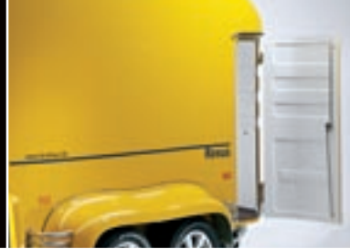
Seitliche Türe mit 3-Punkt-Verriegelung, abschließbar
