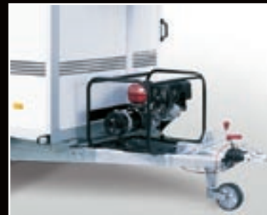
Stromerzeuger auf Deichsel
