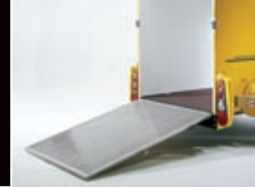
Überfahrwand mit 2 Gasfedern und Aluriffelblech belegt
